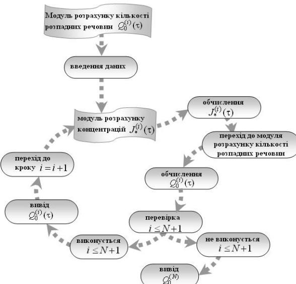
Рис. 4 Схема алгоритму модуля пакету для розрахунку кількості розпадних речовин, що пройшли через нижнюу границю шару за заданий час для моделі гетеродифузії двома шляхами
