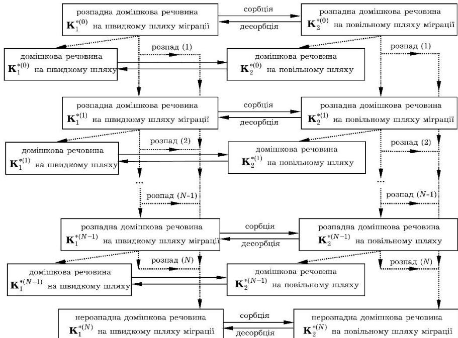
Рис. 1. Схема розпаду домішкової речовини та процесів переходу частинок між станами
